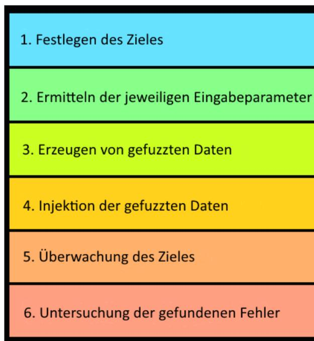
**Abb. 2.1:** Entwurfsphasen des Fuzzing
